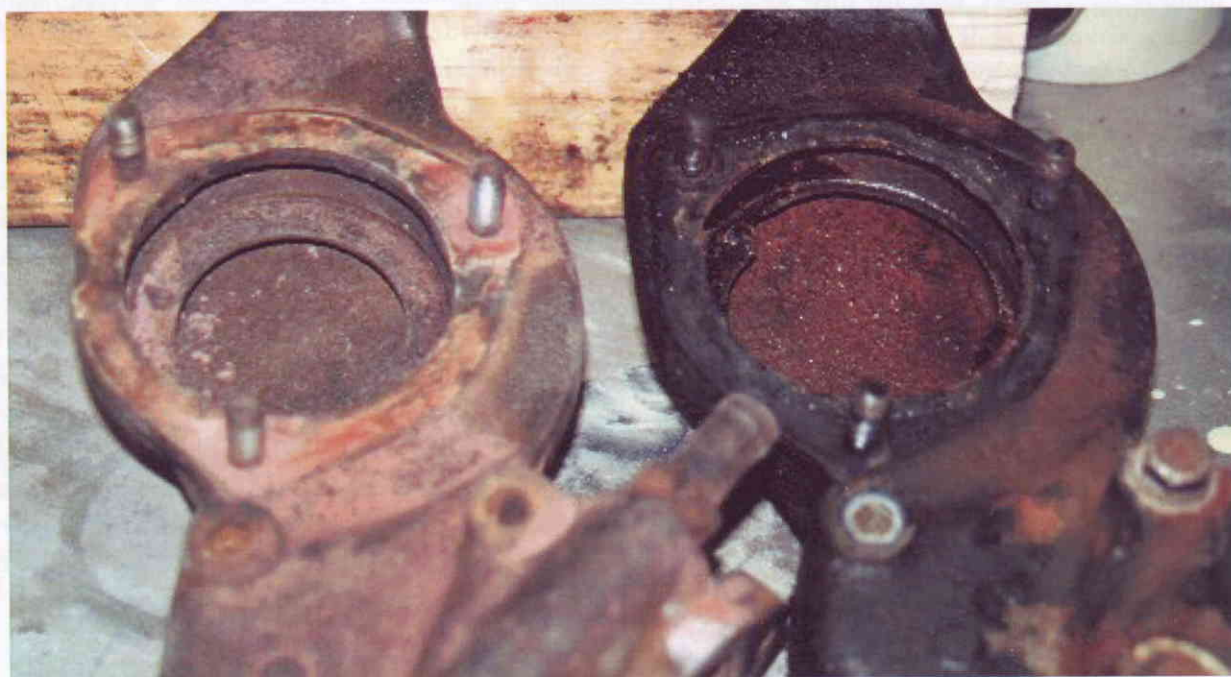
Til højre ses vandpumpehuset hvor flangsen er eroderet helt væk, til venstre ses et brugt vandpumpehus hvor flangsen er intakt.
